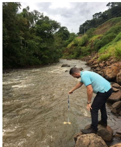
Figura 16 - Exemplo de análise da turbidez de rio pelo método do Disco de Secchi.
