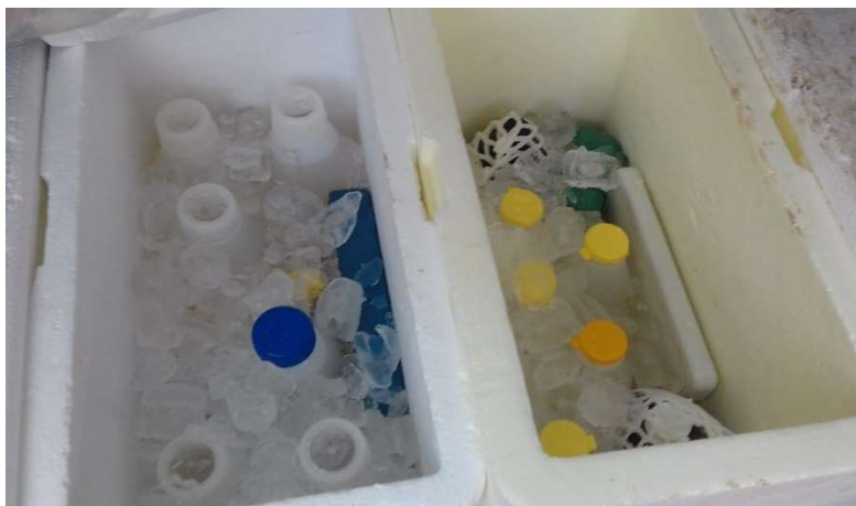
Figura 18 - Exemplo de acondicionamento correto de amostras.
