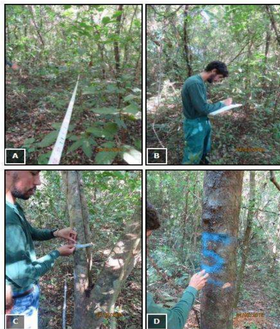
Figura 40 – Método de coleta dos dados brutos e demarcação das unidades amostrais em campo.
